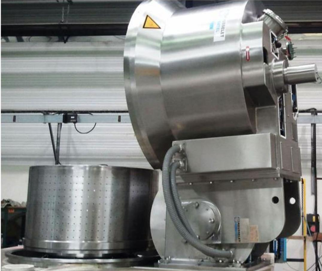
L'ensemble des opérations se fait sous inertage azote pour maintenir le confinement en zone ATEX !
